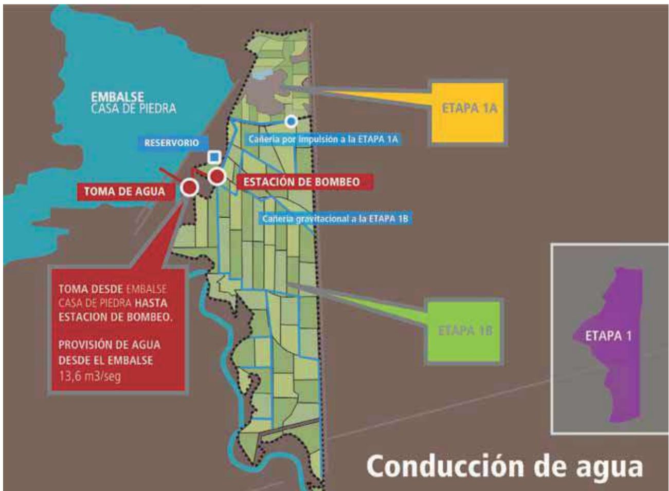
Foto 21. Conducción de agua Etapa1 general del proyecto.
