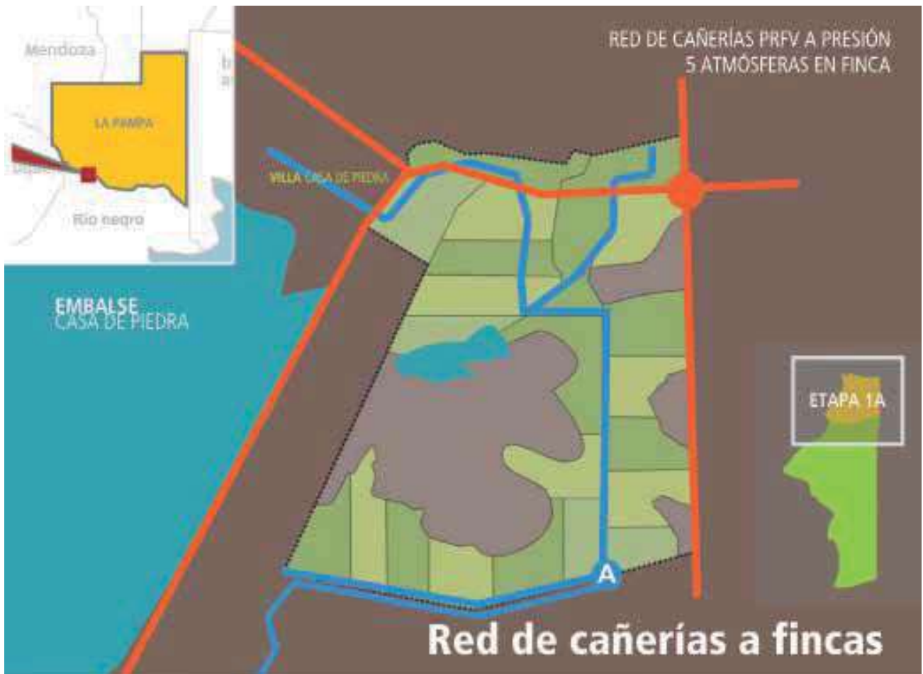
Foto 9. Red de cañerías a fincas.
