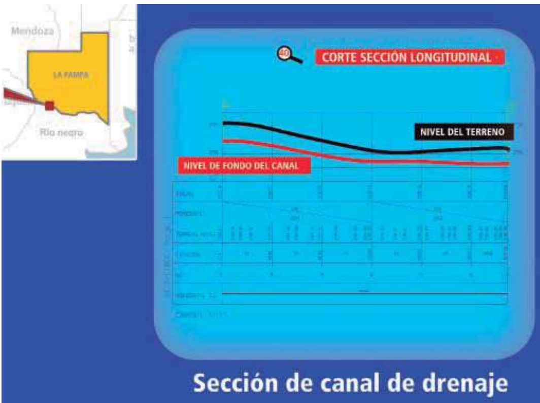
Foto 16. Sección de canal de drenaje.
